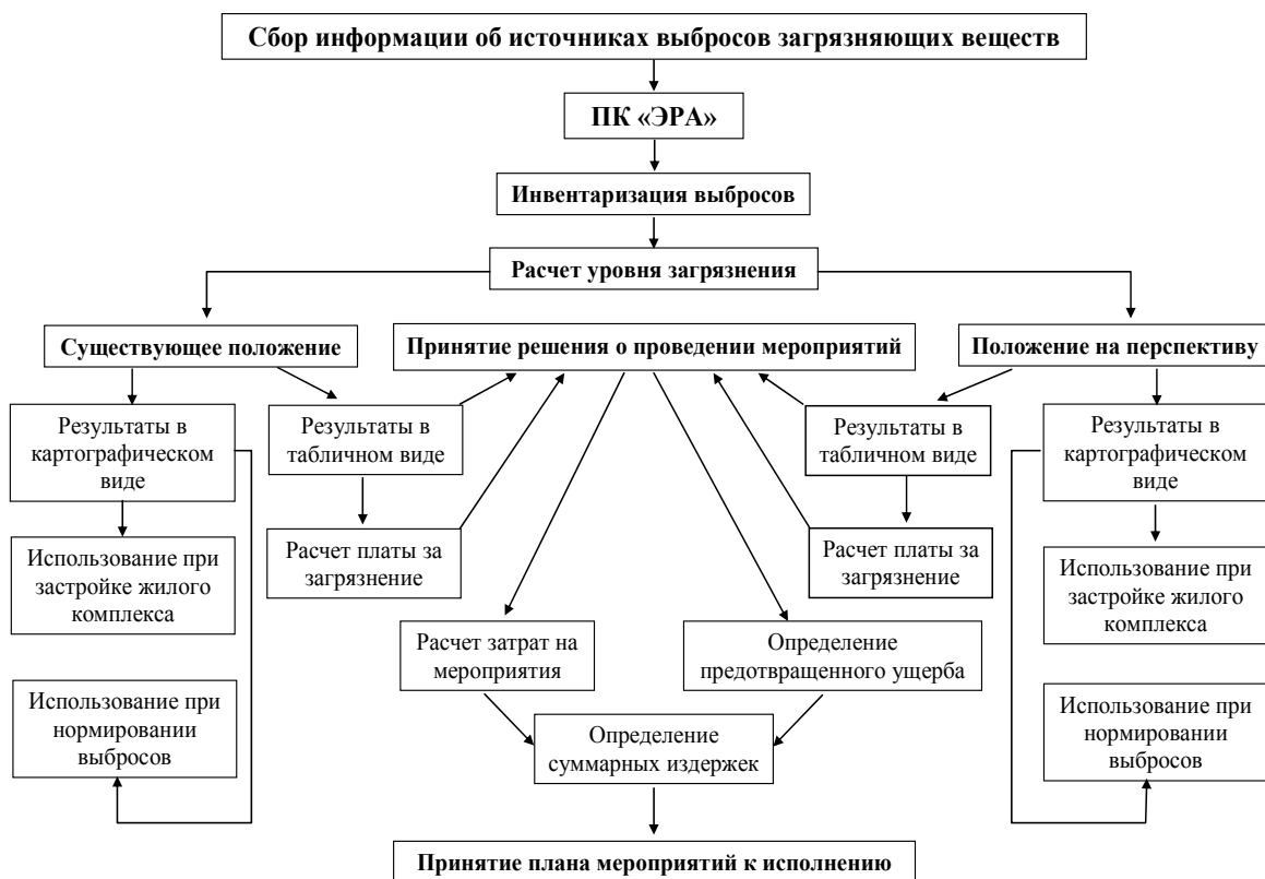
Рис. 2. Алгоритм проведения мониторинга воздействия промышленных предприятий на атмосферу
